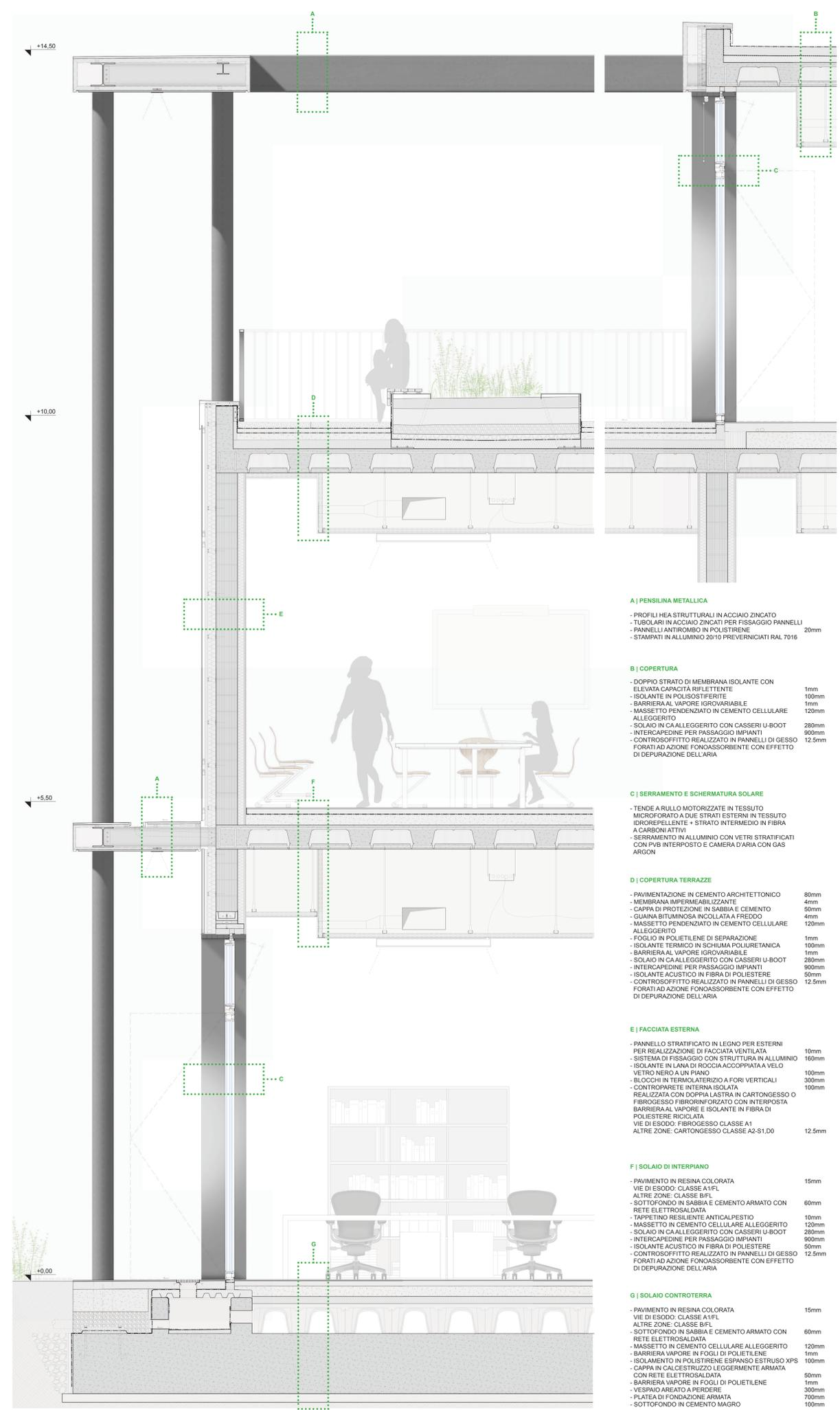
SEZIONE TIPO E PARTICOLARI COSTRUTTIVI DELLA FACCIATA EST | SCALA 1:20
